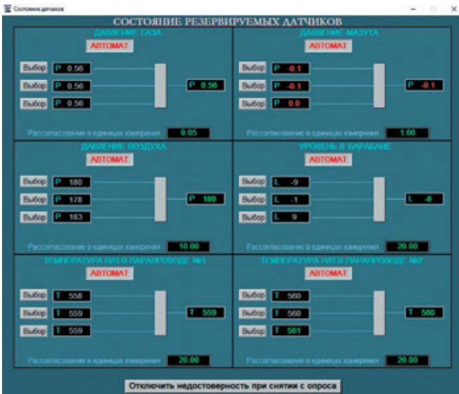
Рис. 4. Мнемосхема контроля резервируемых (тройированных) защитных датчиков
