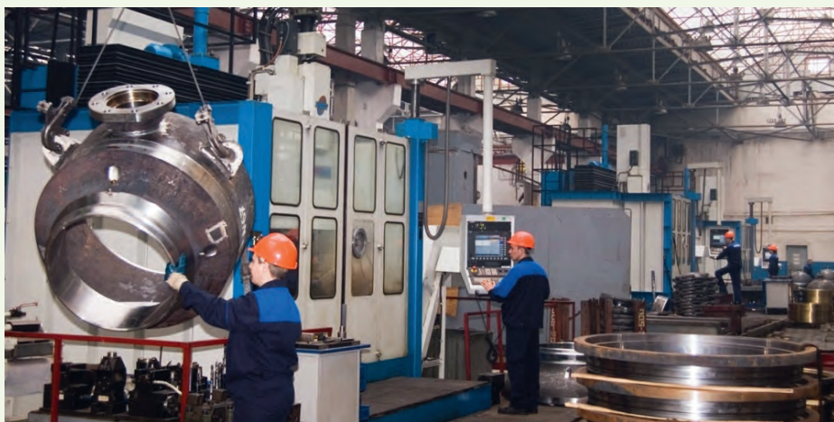
АО «ПТПА»: участок подготовки деталей для шаровых кранов диаметром 700-1400 мм
