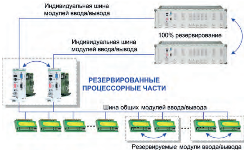
Рис. 2. Схема резервирования контроллеров
