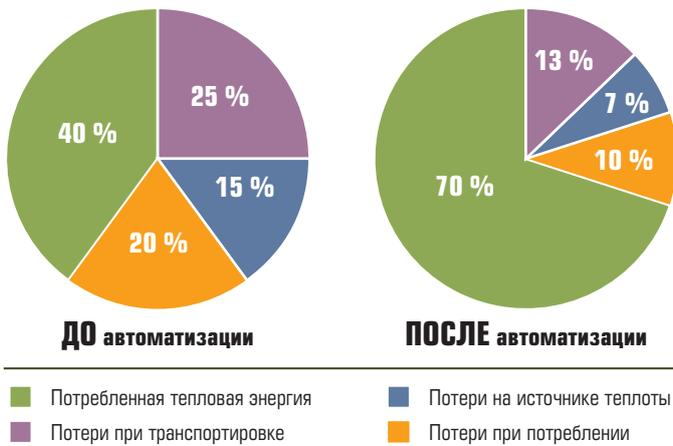
Рис. 1. Значение автоматизации в сокращении потерь в тепловых сетях
